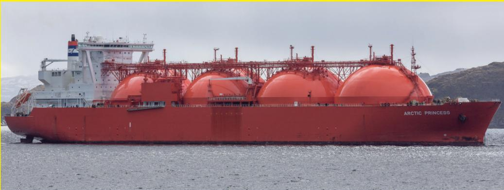
Der LNG-Flüssiggastanker ARCTIC PRINCESS vor Hammerfest. In solchen Tankern mit 125.000–147.000 m<sup>3</sup> Gesamtvolumen wird verflüssigtes Erdgas transportiert. Zuvor wurde es unter sehr hohem Energieaufwand auf -164°C herab gekühlt.
