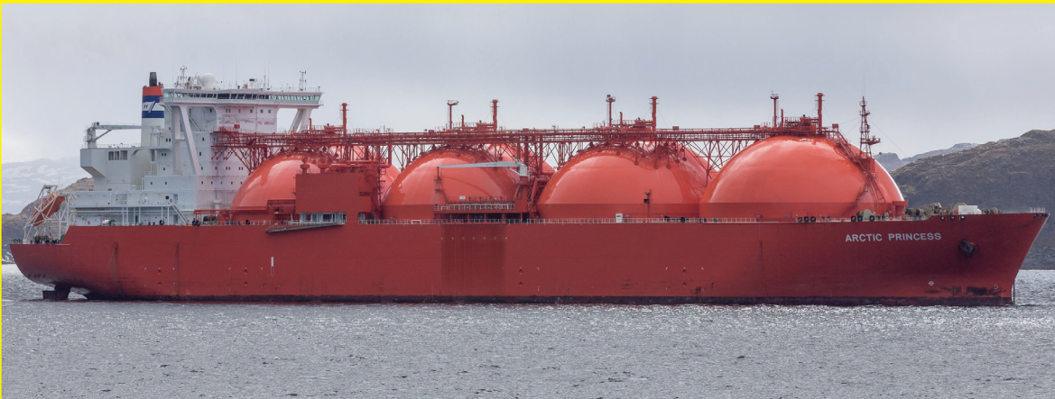
Der LNG-Flüssiggastanker ARCTIC PRINCESS vor Hammerfest. In solchen Tankern mit 125.000–147.000 m 3 Gesamtvolumen wird verflüssigtes Erdgas transportiert. Zuvor wurde es unter sehr hohem Energieaufwand auf -164°C herab gekühlt.
